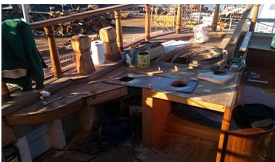
Sur chaque côté du cockpit, une plage est réservée pour intégration des winchs électriques. Une plaque d'inox soudée sur une structure métallique existante sert de renfort pour les winchs.
