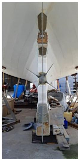
Le gouvernail et l'hélice sont en place définitivement et le talon de quille est résiné pour terminer l'étanchéité.
