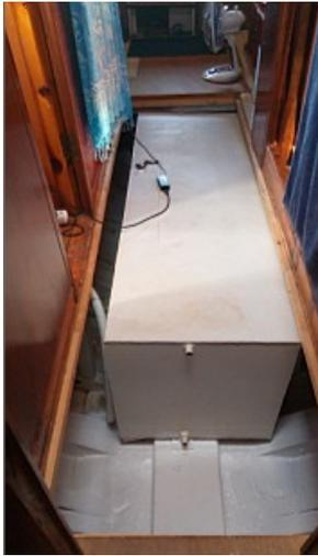
Les anciens tanks ont été retirés et remplacés. Le tank d'eau douce de 972 litres occupe la partie centrale des fonds de cale. En avant, et proche de l'emplanture du mat principal viendra le tank d'eau noires de 670 litres. L'emplanture recevra une épontille qui supportera le mat principal.
