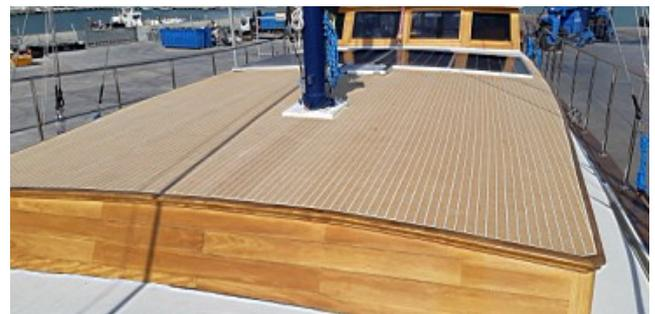
Les rainures formant joints sont remplies d'un polymère blanc en attente de ponçage. Du roof on passe sur la plateforme avant avec la courbure imposée par la soleta.
