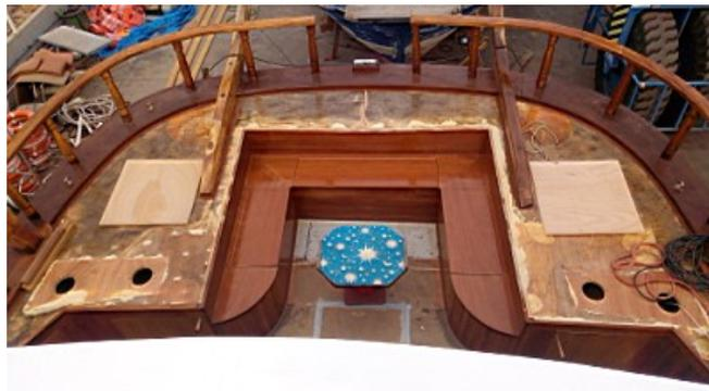
Sur le toit de la timonerie, le mât n'est plus présent et les enduits en cours. Un portique est en construction pour supporter la mât après restauration.
