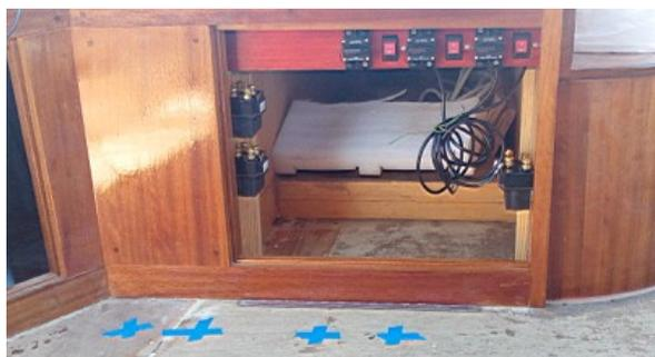
En cockpit, les aménagements électriques des winchs sont en cours avec les commandes manuelles ici coté Tribord des 2 winchs et du tambour de la ligne de mouillage arrière qui sont à l'abri à l'intérieur du coffre. Les commandes aux pieds seront installées en dernier.
