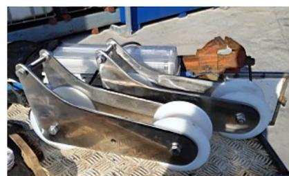
Les roues en téflon et les daviers ont été fabriqués aux dimensions des bras des ancres. Pour supporter ce système, on a réalisé un ceinturage du beauprés avec appuis sur la soleta, et dont la partie frontale est arrondie de son épaisseur.
