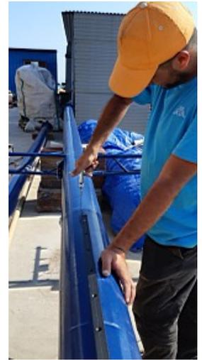
Les barres de flèches sont soudées et le haubannage révisé a été replacé dans ses guides.
