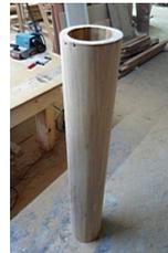
La future colonne de barre à roue qui doit intégrer les circuits hydrauliques et électroniques, la pompe, le compas magnétique,
