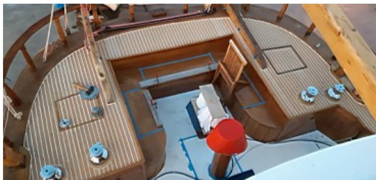
La zone d'étrave et des bittes d'amarrage est parquetée de lames d'Iroko, pour résister aux chocs et aux frottements. Ces lames poursuivent les lignes du seacorck.
