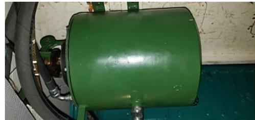
L'installation hydraulique est composée d'une centrale attelé au moteur à vitesse variable couplée d'un tank sur l'avant d'où partent les tuyaux vers le guindeau et vers le propulseur d'étrave.
