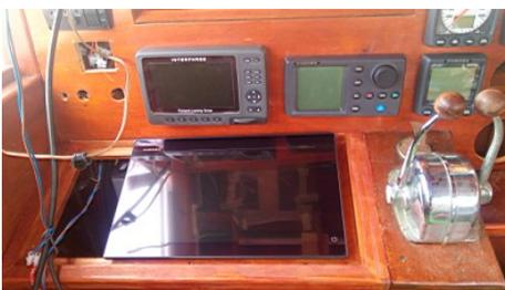
L'écran tactile du TLTZ15F de Furuno, est doublé par un ordinateur avec écran tactile qui permet des précisions de route avec Maxsea Time Zero et le programme Navigator V3.3
