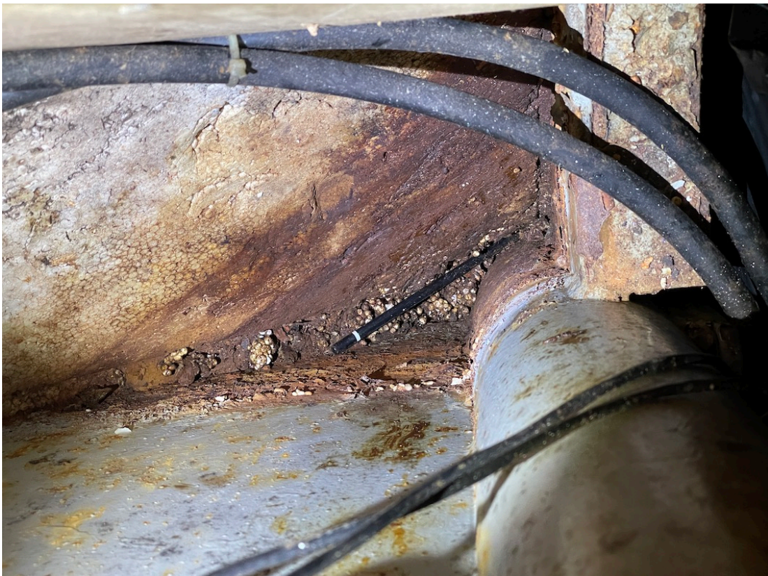
Abb.#31: Blick von oben auf das Untere Ruderlager, hier stand einmal Wasser in diesem Kompartment
