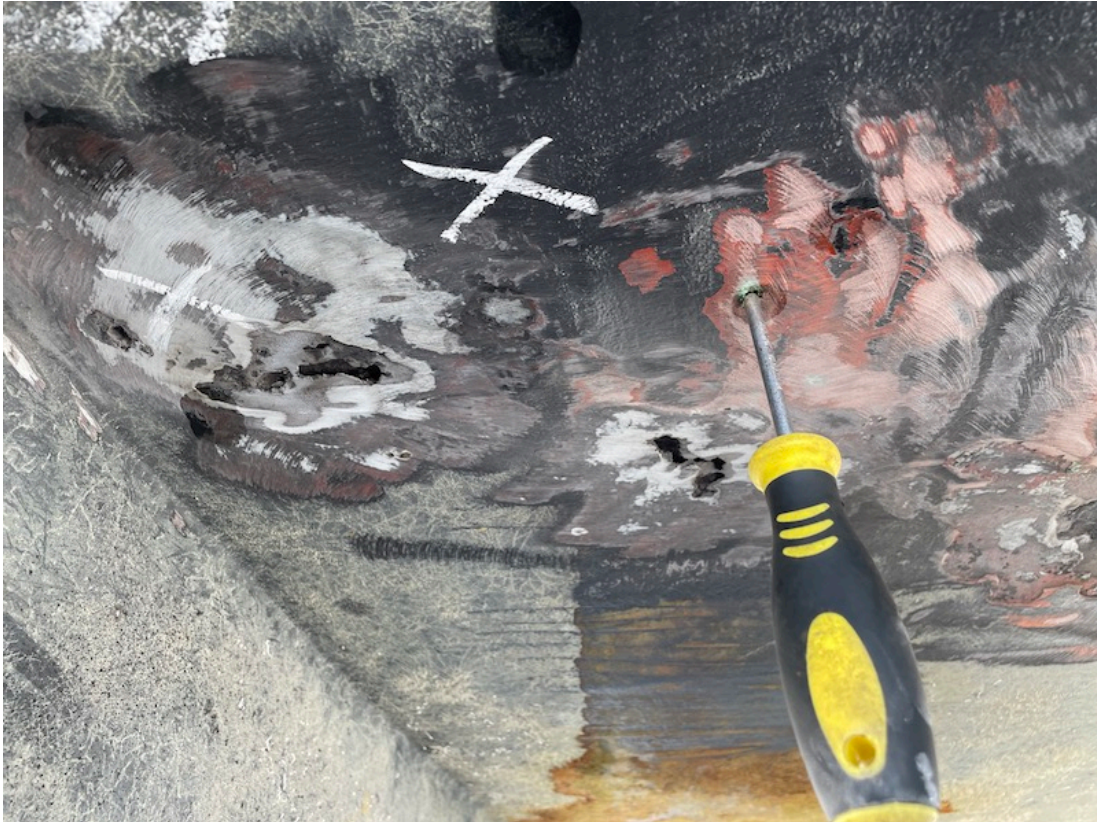
Abb.#20: Weitere Löcher kamen während der Messung des Bereiches zum Vorschein
