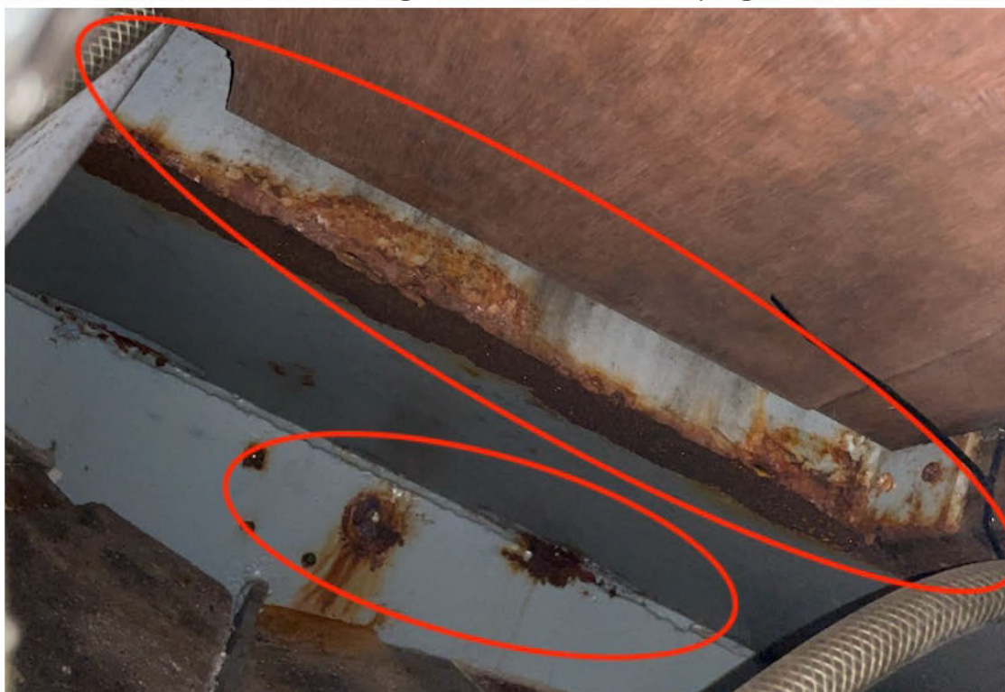
Abb.#29: Korrosion am Spiegel und am Decksbalken
