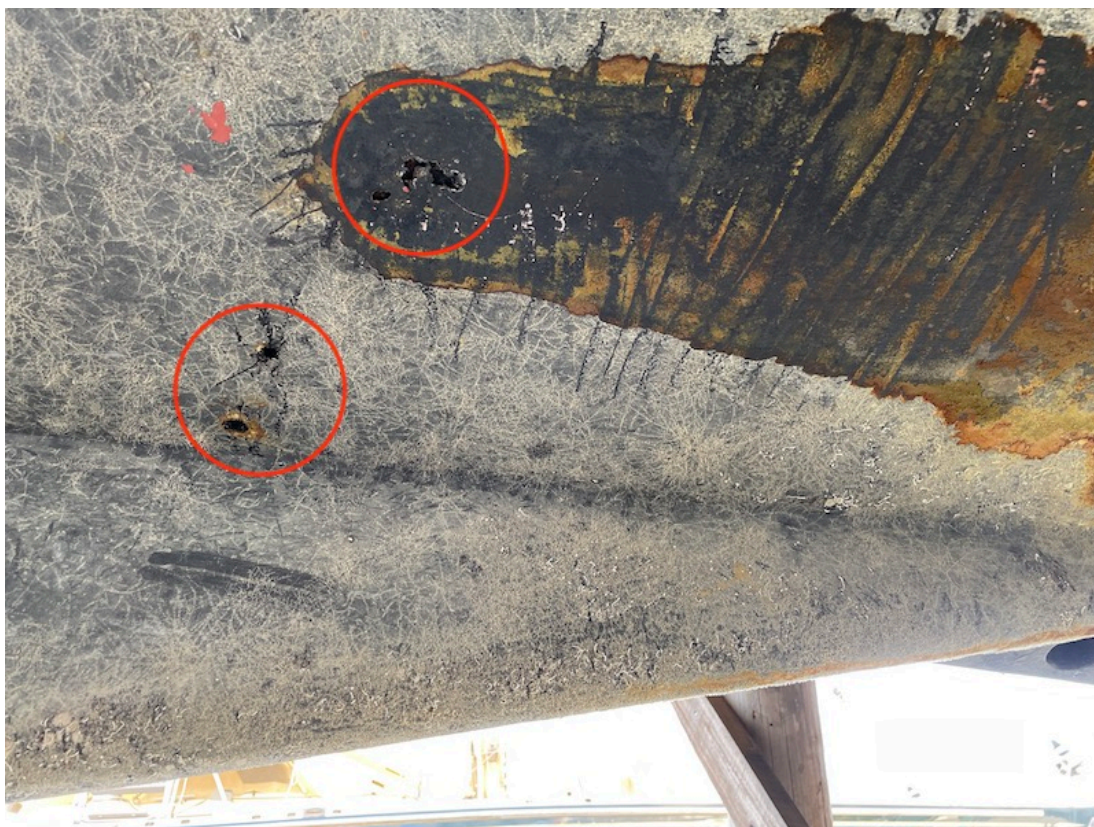
Abb.#12: Blick auf die Löcher, die ohne Entfernen des Antifoulings sichtbar waren
