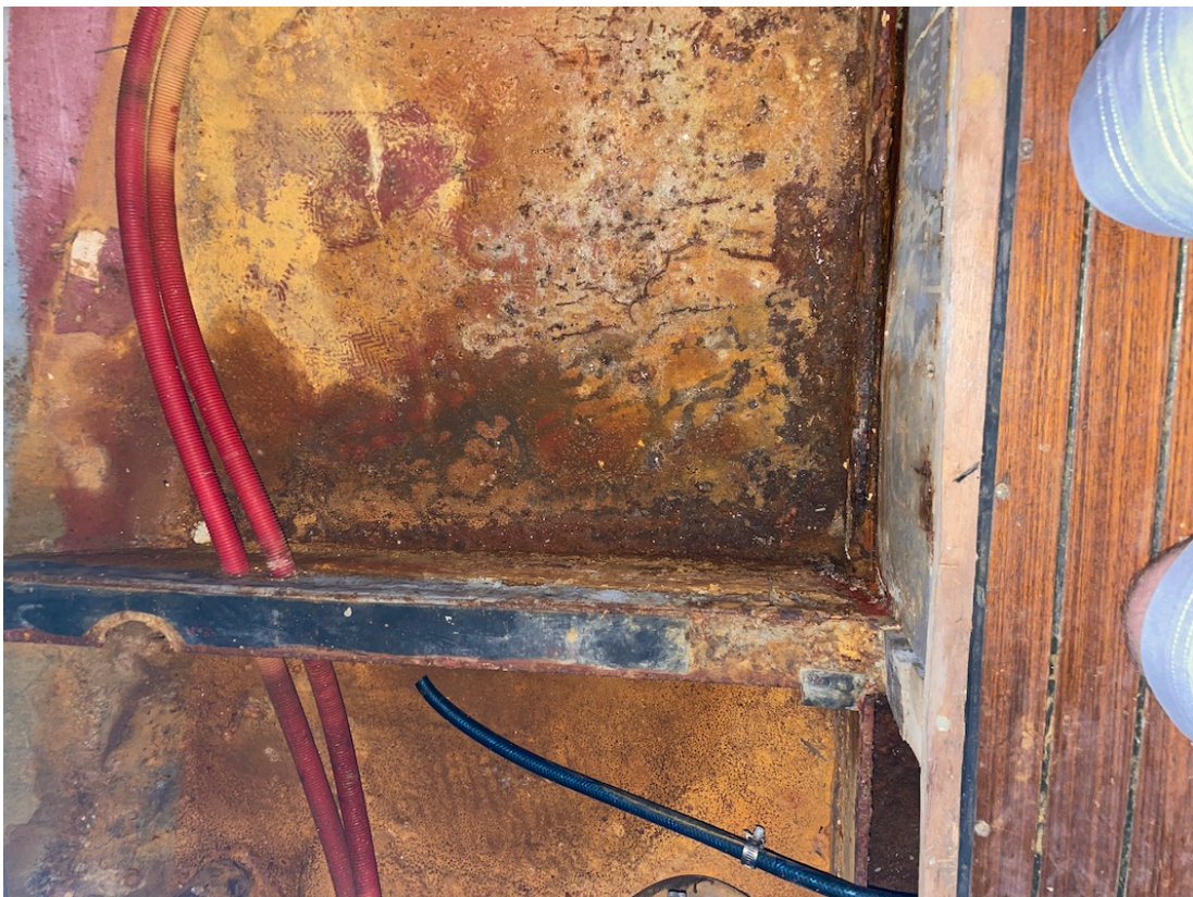
Abb.#8: Blick in die Bilge unterhalb der Duschwanne in der hinteren Nasszelle, stark korrodierte Bodenplatte
