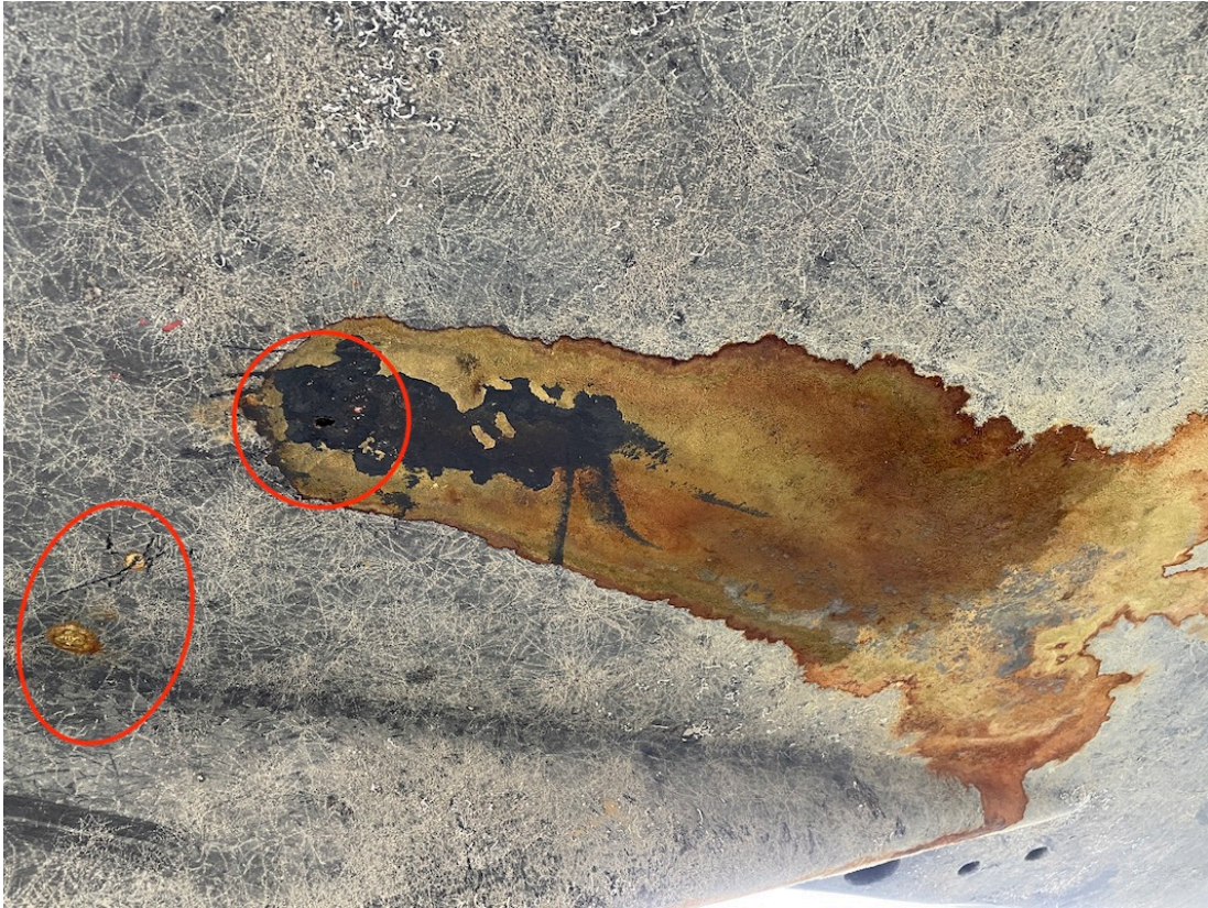
Abb.#7: Erstes Foto des betroffenen Bereiches im Unterwasserschiff, rot markiert zwei kleine Löcher im Stahl
