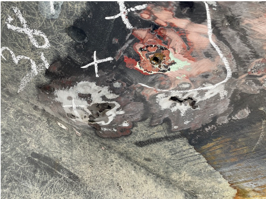
Abb.#21: Loch war ebenfalls mit Spachtel komplett verschlossen
