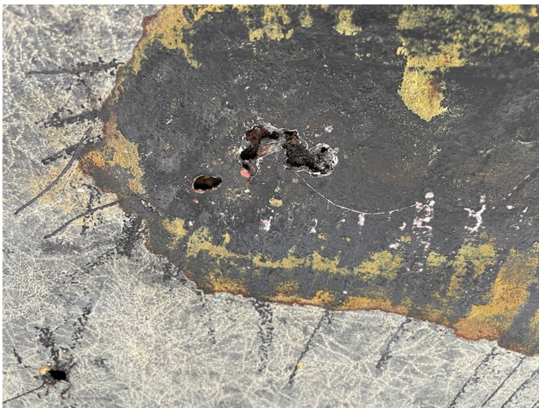
Abb.#13: Stark korrodierte Platter mit < 1mm Restplattenstärke
