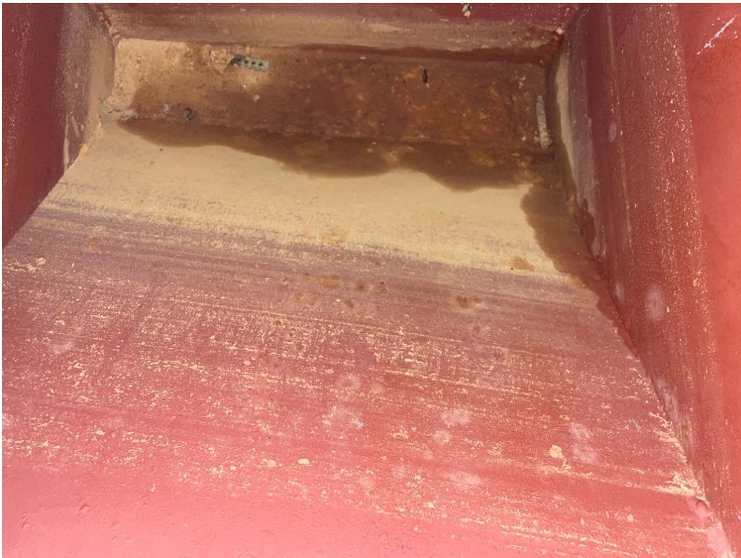
Abb.#32: Blick von oben in die Bilge unterhalb der Galley, Wasserlinien und Dreck in der Bilge erkennbar, hier stand einmal viel Wasser
