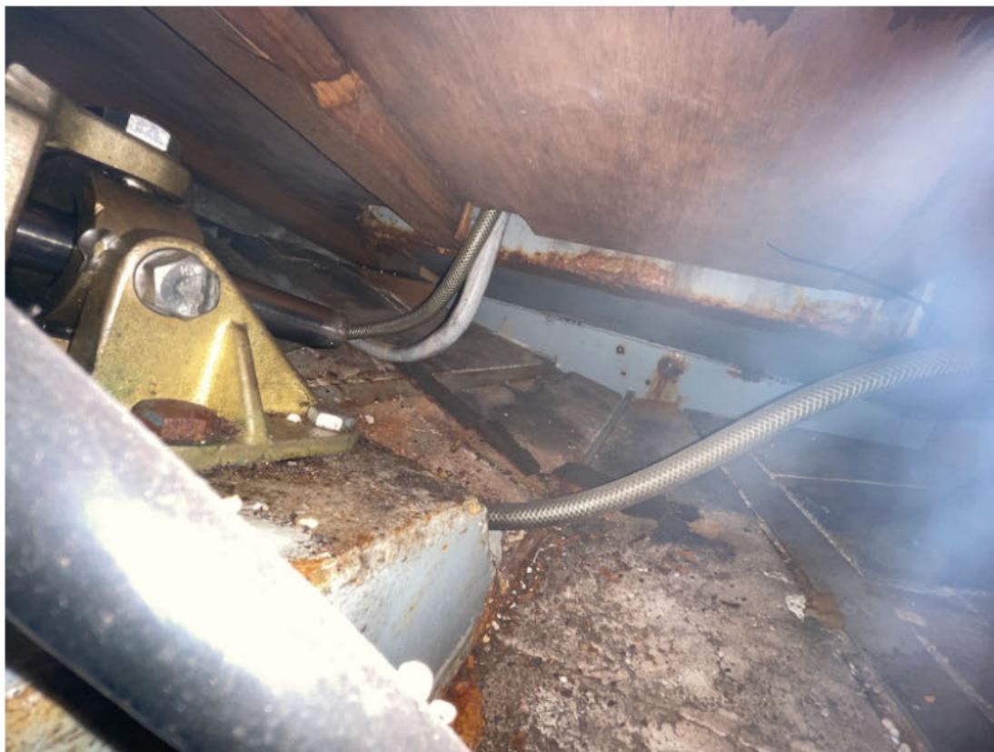
Abb.#28: Blick von der Ruderanlage nach achtern zum Spiegel, Korrosion erkennbar
