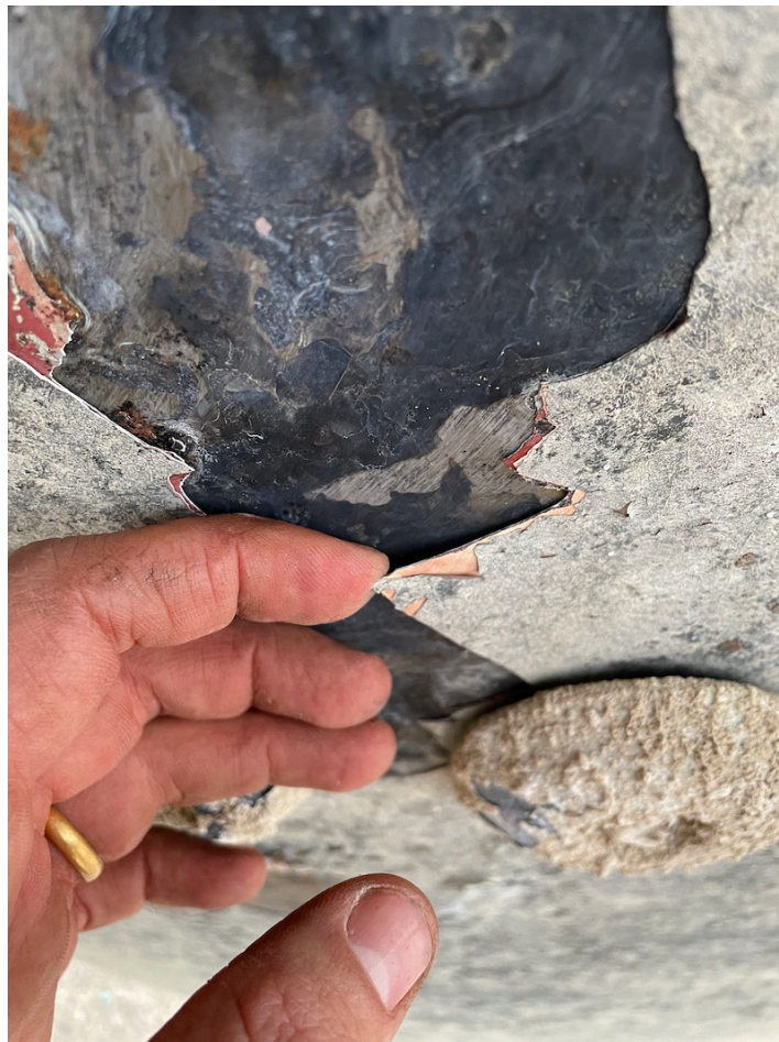
Abb.#33: Der Anstrich lässt sich leicht entfernen, keine Verbindung zwischen Stahl und der ersten Grundierung
