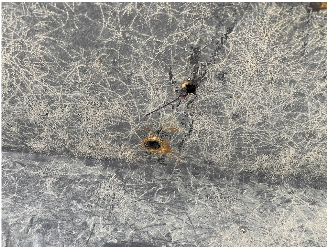
Abb.#14: Zwei kleine Löcher neben der Propellerwelle
