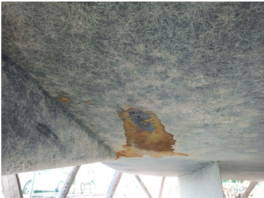
Abb.#4: Loch von aussen sichtbar
