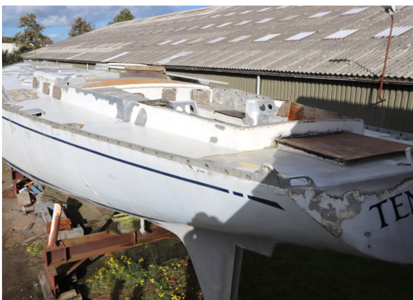
Von der ursprünglich sehr soliden Substanz des Schiffes konnte ein großer Teil erhalten werden, allerdings muss das Kasko noch komplett gestrahlt werden.
