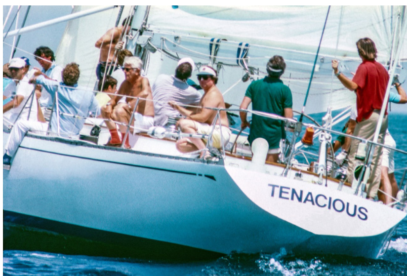
Von achtern werden die klassischen Linien der Yacht besonders deutlich, der negative Spiegel deutet auf eine frühe IOR-Konstruktion mit langen Überhängen und gemäßiger Breite.
