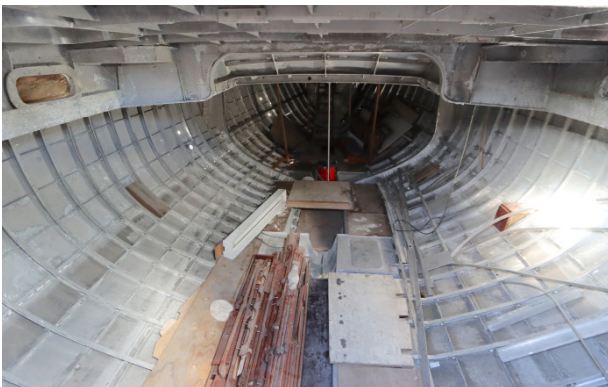
Das Kasko zeigt eine klassische Bauweise mit einem sehr dicht stehenden Spantengerüst, was für einen sehr stabilen und verwindungssteifen Rumpf sorgt.
