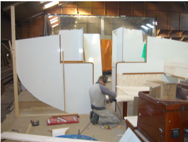
Das Interieur wurde ausgebaut, um neue Elemente an alte Sektionen anzupassen. Viele weiße Flächen mit hölzernen Umleimern sorgen für ein klassisches Ambiente.
