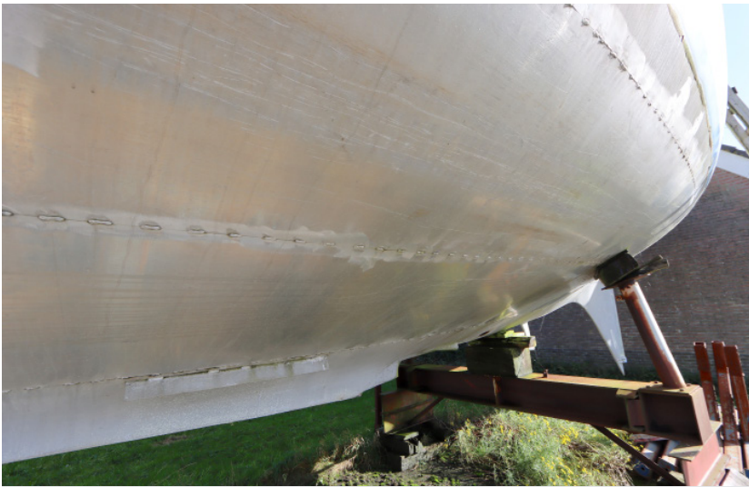
Am Unterwasserschiff wurde ein großer Teil der Rumpfbeplattung ersetzt, auch hier fehlt noch viel Feinarbeit.
