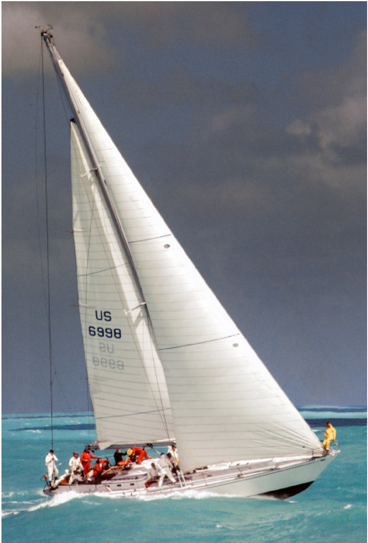
Die schweren Konstruktionen der frühen 70er Jahre mit scharfen Vorschiffslinien fühlten sich vor allem an der Kreuz und bei viel Wind und Welle wohl, auch TENACIOUS zeigt aus heutiger Sicht alle Elemente eines klassischen Seeschiffes, einschließlich des stabilen Toppriggs mit großen Vorsegeflächen.
