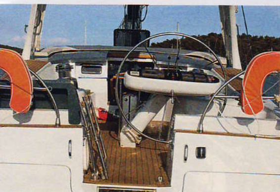
Schwenkbare Zentrale. Der Clou: Das Steuerpult bleibt stets horizontal
